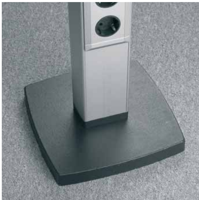
Tung fot med en unik kileinnfesting. Stavprofilen plasseres ovenpå foten, deretter slås en liten kile inn og profilen står stabilt.
